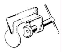
18G672 DISC BRAKE PISTON COMPRESSOR
