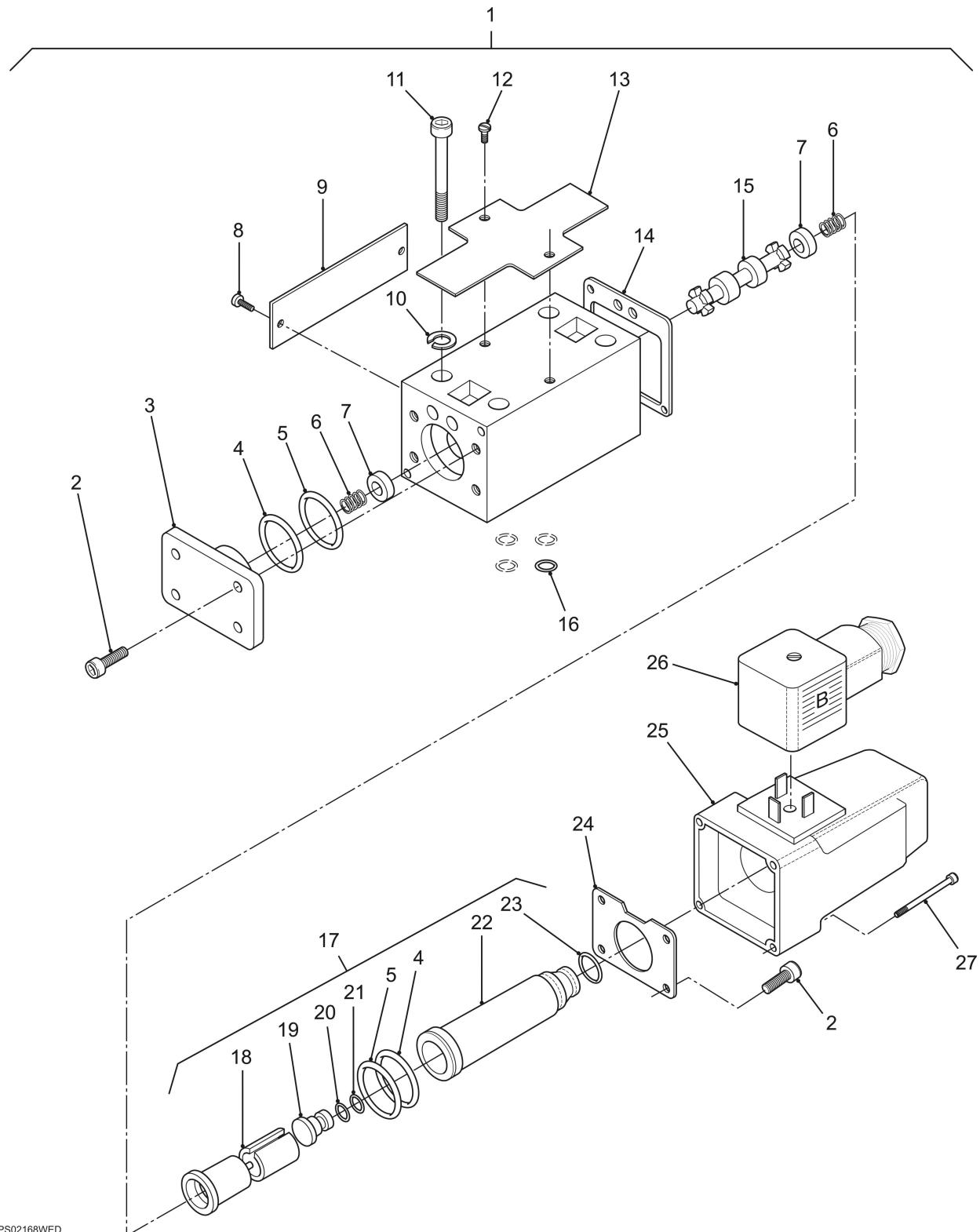
**SOLENOID CONTROLLED RELIEF VALVE ASSEMBLY**
